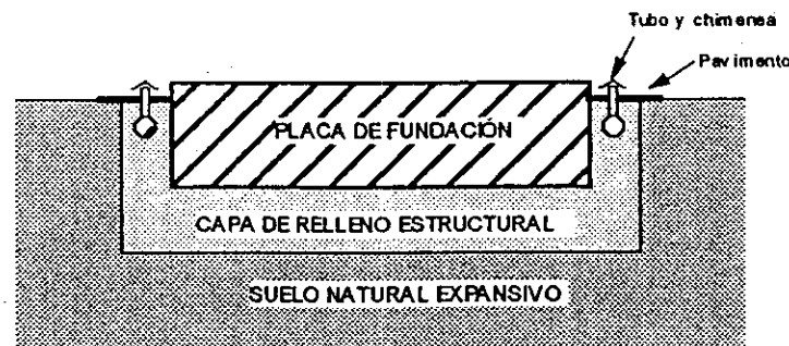
RELLENO ESTRUCTURAL BAJO LA PLACA DE FUNDACIÓN
